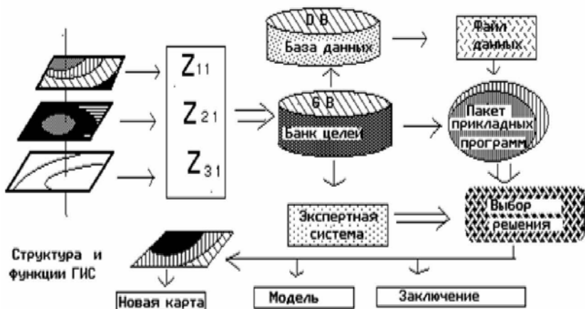
Рис. 3. Структурно-функциональная схема ГИС.
