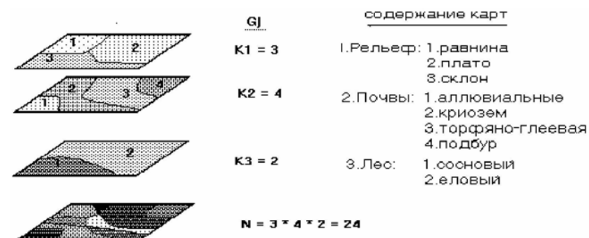
Рис. 5. Картографическая классификация перечисления.
